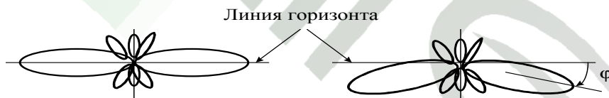
Рис. 6.5. Иллюстрация наклона диаграммы направленности в вертикальной плоскости
