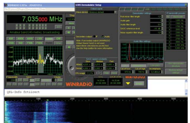
Bild 5: Ausprobieren der variablen ZF-Filter für PSK31
