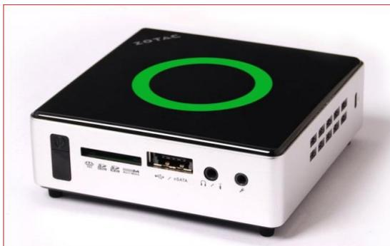
Определяющим фактором при выборе были его габариты (106x106x37 мм!), при том, что это полноценный и весьма продвинутый по конфигурации неттоп.
